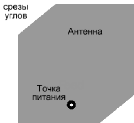
Рис. 10.3. Принцип питания GPS антенны с помощью одной точки. Изменение сечения удобно для подстраивания, поскольку увеличение среза увеличивает разность фаз между двумя парами щелевой линии.
