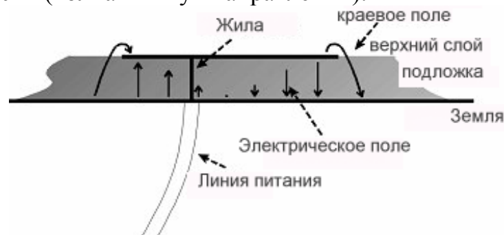
Рис. 10.2. Распределение электрического поля в сечении антенны GPS
